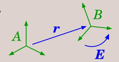
$${}^{B}\boldsymbol{X}_{A} = \begin{bmatrix} \boldsymbol{E} & \boldsymbol{0} \\ \boldsymbol{0} & \boldsymbol{E} \end{bmatrix} \begin{bmatrix} \boldsymbol{1} & \boldsymbol{0} \\ \boldsymbol{r}^{T} & \boldsymbol{1} \end{bmatrix} \quad \text{where} \quad \boldsymbol{\tilde{r}} = \begin{bmatrix} 0 & -r_{z} & r_{y} \\ r_{z} & 0 & -r_{x} \\ -r_{y} & r_{x} & 0 \end{bmatrix}$$
