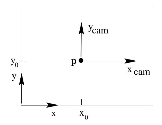
$$\mathbf{x} = \begin{pmatrix} x \\ y \\ 1 \end{pmatrix} = \frac{1}{f} \begin{bmatrix} \alpha_x & x_0 \\ \alpha_y & y_0 \\ & 1 \end{bmatrix} \begin{pmatrix} x_{\text{cam}} \\ y_{\text{cam}} \\ f \end{pmatrix} = \mathbf{K} \begin{pmatrix} x_{\text{cam}} \\ y_{\text{cam}} \\ f \end{bmatrix}$$
